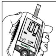
**Hinweis:** Wenn das Messergebnis für  $\beta$ -Keton über 8,0 mmol/L liegt, wird im Display „HI“ zusammen mit „Ket“ angezeigt; wenn das Messergebnis für  $\beta$ -Keton unter 0,1 mmol/L liegt, wird im Display „LO“ zusammen mit „Ket“ angezeigt.
