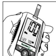
**Hinweis:** Wenn das Messergebnis über 600 mg/dL liegt, wird im Display "HI" angezeigt; wenn das Messergebnis unter 20 mg/dL liegt, wird im Display "LO" angezeigt.
