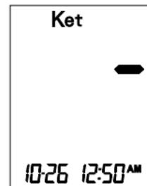
**Hinweis:** In diesem Displayzyklus wird das Display durch Drücken einer BELIEBIGEN Taste auf die Anzeige des Blutzuckerwertes fixiert. Der Anwender kann dann mit Hilfe der linken/rechten Taste zwischen der Markierung und Nicht-Markierung des Messergebnisses hin und her wechseln.
