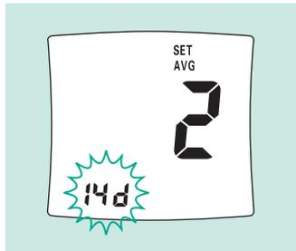
Zum Erhöhen oder Verringern der Anzahl der Tage drücken Sie eine der Tasten **▲** oder **▼**; halten Sie eine der Tasten **▲** oder **▼** gedrückt, um den Wert schnell fortlaufend zu erhöhen oder zu verringern. Wenn die richtige Anzahl von Tagen angezeigt wird, drücken Sie die Taste **Ⓢ**, um den nächsten Durchschnittszeitraum einzustellen. Während der Einstellung des Durchschnittszeitraums wird das „AVG“-Symbol angezeigt.
