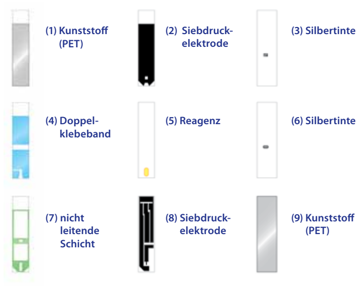
Abb. 4. Aufbau des BGStar® Teststreifens.
